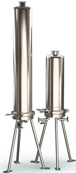
Die Filtergehäuse der SN-AL-Serie sind komplett aus Edelstahl 1.4404 gefertigt und für die höchsten Reinheitsanforderungen in der Pharma-, Kosmetik-, Getränke- und Elektronikindustrie konzipiert. Die Gehäuse haben eine polierte Oberfläche und weisen keinerlei „tote“ Ecken und Kanten auf. Sie können zusammen mit den Filterelementen dampfsterilisiert oder chemisch desinfiziert werden.
